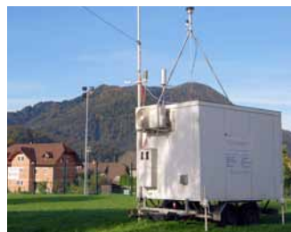
Mobilna postaja za merjenje kakovosti zraka je od oktobra dalje postavljena nad športnim parkom pri OŠ Škofja Loka – Mesto.
